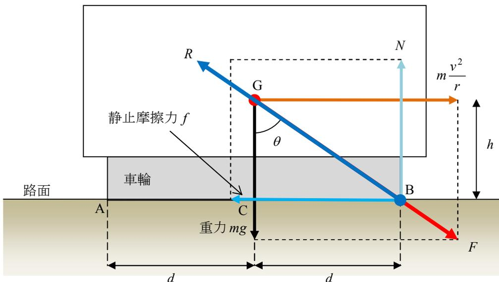
$v$ が大きくなっていくと、遠心力も大きくなっていくため、抗力の作用点は  $B$  へと移動していく。
