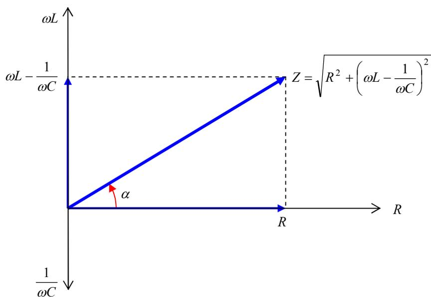
また、起電力と電圧の実効値を  $\bar{V}$ ,  $\bar{V}_L$ ,  $\bar{V}_C$ ,  $\bar{V}_R$  とすると、下図のようになる。
