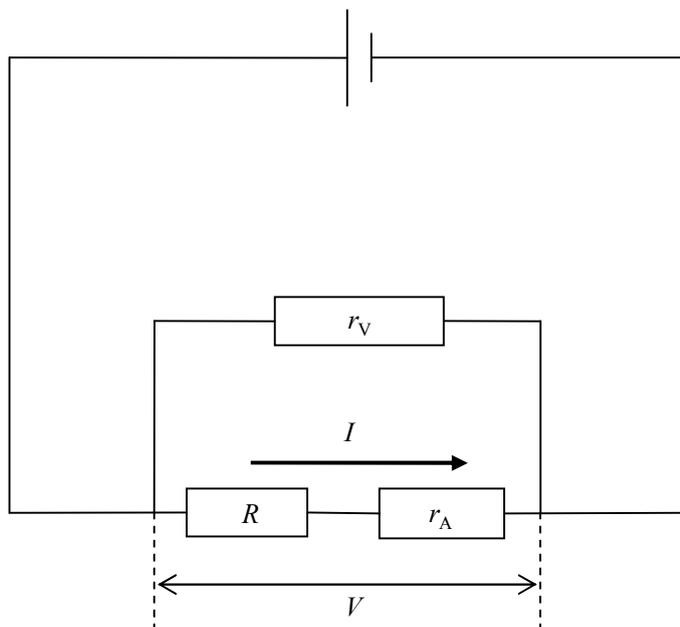
電圧計が示す値は抵抗  $R$  の電圧と電流計の内部抵抗  $r_A$  の電圧の和であり、
