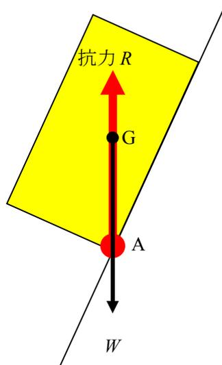
さらに傾きを大きくすると抗力の作用線と重力の作用線が異なってしまうので物体は  $A$  を軸に回転する。すなわち転倒する。
