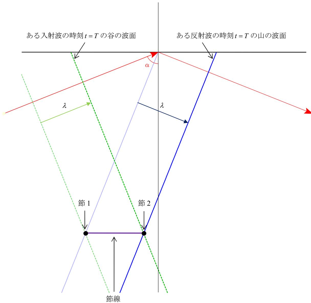
同様にして、任意の山の波面と谷の波面が移動し、生成する節を結ぶと、次のような節線が出来上がる。
