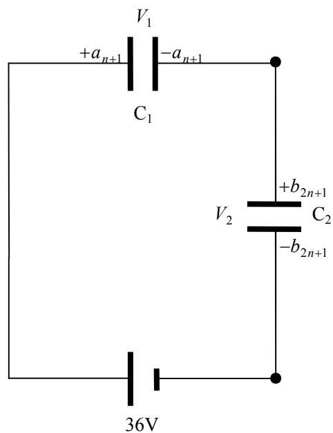
$C_1, C_2$  の電圧をそれぞれ  $V_1, V_2$  とすると,
