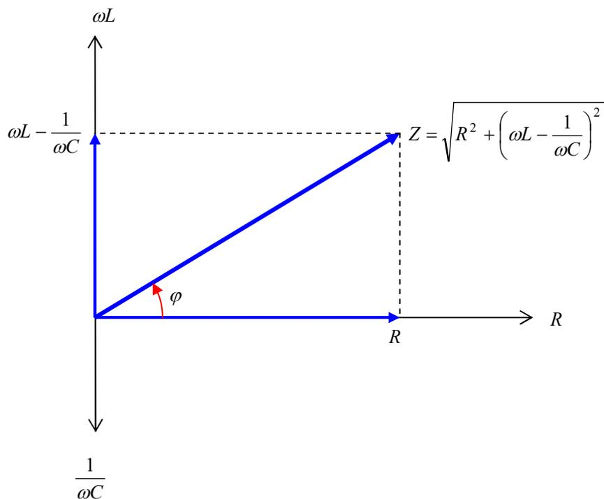
また、起電力と電圧の実効値を  $\bar{V}$ 、 $\bar{V}_L$ 、 $\bar{V}_C$ 、 $\bar{V}_R$  とすると、下図のようになる。
