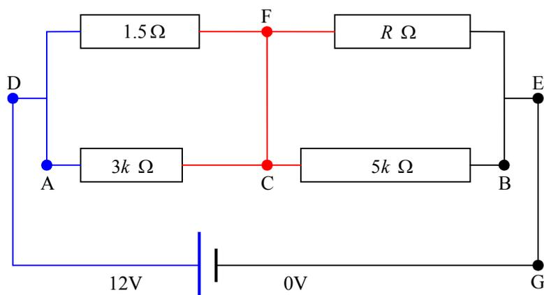
AC間の抵抗の大きさとCB間の抵抗の大きさの比はそれぞれの抵抗の長さの比と等しいから、AC間の抵抗の大きさを $3k\ \Omega$ とするとCB間の抵抗の大きさは $5k\ \Omega$ となる。
