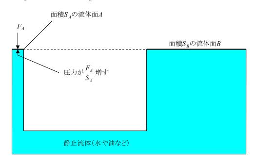
流体はまだ静止しているから、作用反作用の法則により、 外力 $F_4$ に対し、大きさ $F_4$ の抗力が発生する。
