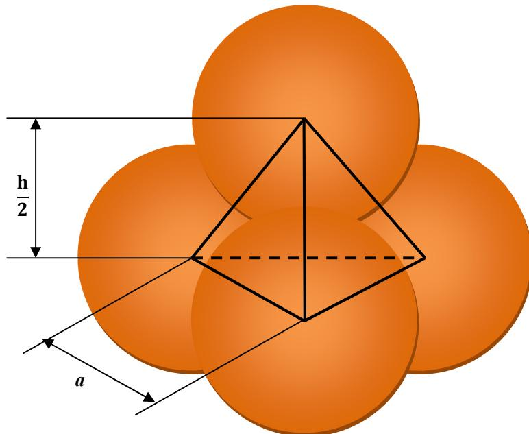
一辺の長さ  $a$  の正四面体 ABCD の頂点 A から底面に下ろした垂線の足を H とする。
