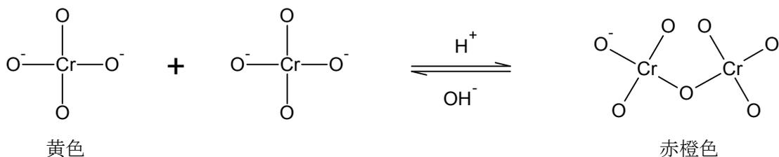
溶液の液性が酸性のとき :  $2\text{CrO}_4^{2-} + 2\text{H}^+ \rightarrow \text{Cr}_2\text{O}_7^{2-} + \text{H}_2\text{O}$
