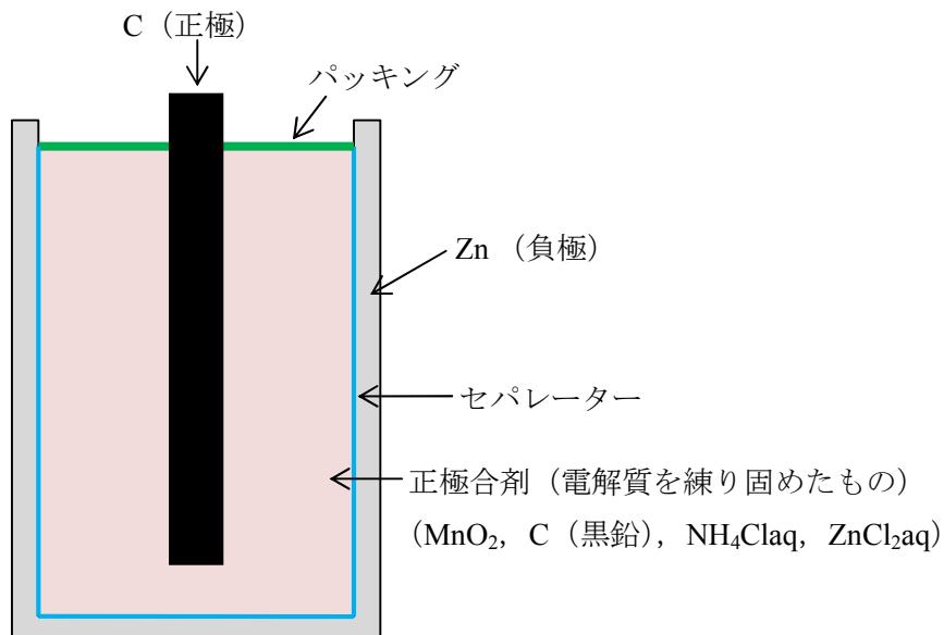
(-) Zn | ZnCl<sub>2</sub>aq, NH<sub>4</sub>Claq | MnO<sub>2</sub>, C (+) 起電力は約 1.5V
