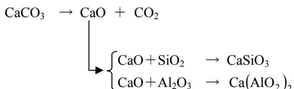
不純物の  $\text{SiO}_2$  と  $\text{Al}_2\text{O}_3$  は  $\text{CaO}$  と反応し  $\text{CaSiO}_3$  と  $\text{Ca}(\text{AlO}_2)_2$  となる。これをスラグという。
